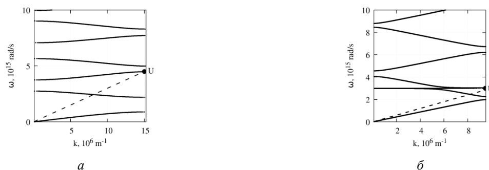
Рис. 1. Поляритонные спектры ГФК на основе искусственных опалов: (а) кристалл с диаметром глобул D = 250 нм, заполненный модельной средой с показателем преломления n = 7 ; (б) образец с D = 400 нм, легированный «резонансной» примесью ( \text{Eu}_2\text{O}_3 ) в запрещённой фотонной зоне композита [4]. Сплошные линии соответствуют поляритонным ветвям \omega = \omega(k) , пунктиром показан закон дисперсии света в вакууме \omega = c \times k , пересечение U – точка унитарных поляритонов
