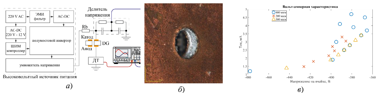
Рис. 1. Схема экспериментальной установки (а), микрофотография отверстия катода (б) и вольт-амперная характеристика (в)
