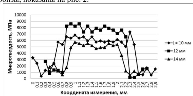
Рис. 1. Распределение микротвердости в наплавленных валиках из сплава ПГ-12Н-01
