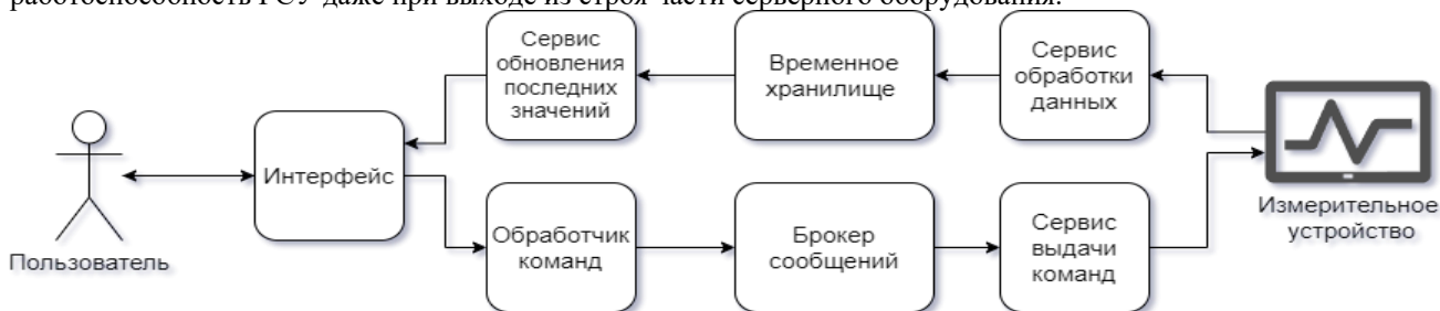
Рис. 1. Цепочка доведения целевой информации от измерительного устройства и обратно – в виде выдачи команд управления на прибор.
