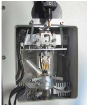
Уникальный сканирующий зондовый нанограф SNOTRA-1, размещенный в криокамере ультрамикротом
